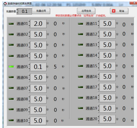
图 4.8 存储间隔操作界面
