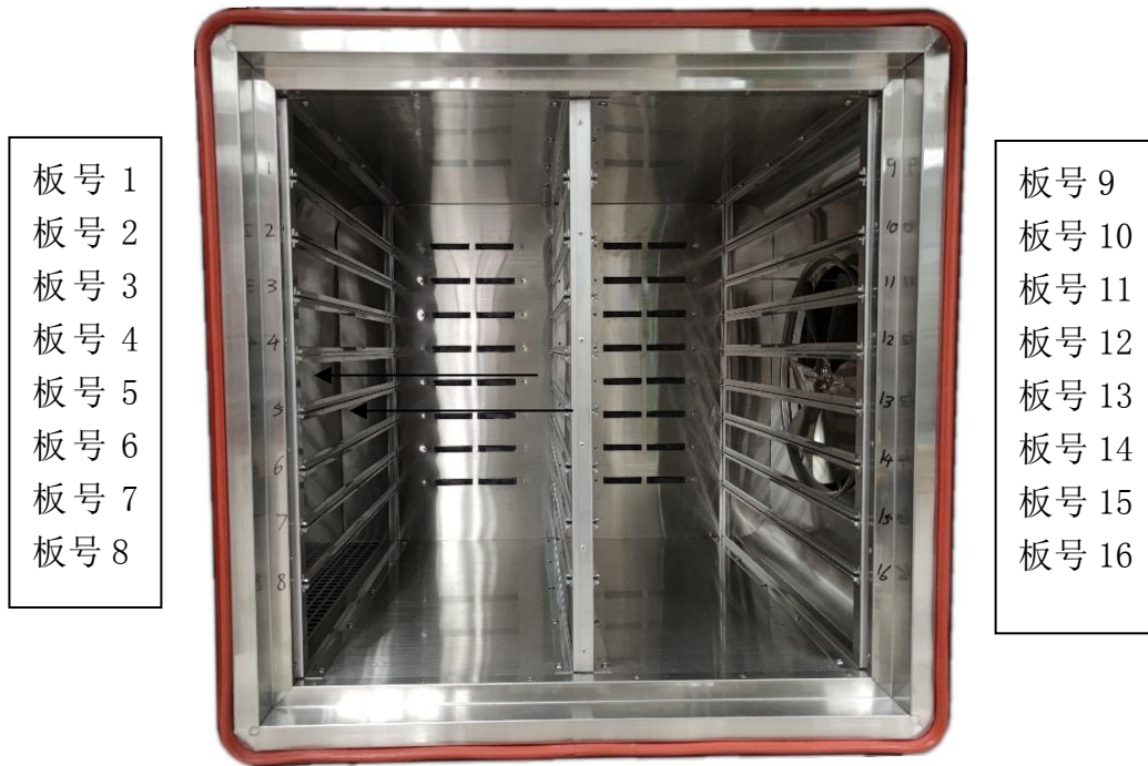
(图 4) 温箱内部结构图
